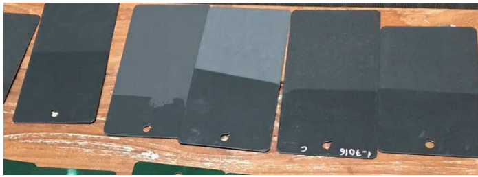
Verschiedene Testbleche nach Tauchversuchen in Wasser. Aufgrund von Wassereinlagerung ist eine deutliche Aufhellung der Bleche erkennbar
