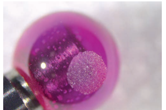
Verschleiß am Standard-Rubintastereinsatz nach 4.000 m
