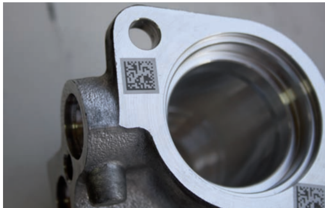
Mit der Lasertechnik lassen sich Beschriftungen und Codierungen mit Strichcodes und Datamatrix durchführen
