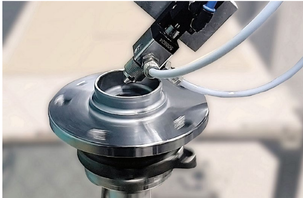
Das optimierte Spritzverfahren ermöglicht es, Bauteile randscharf, ohne Maskierung mit Zinklamellensystemen zu beschichten.
