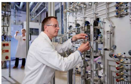
Um die geeigneten Filtersubstanzen zu finden, nutzen die Forschenden des Fraunhofer IWS eine Multi-Adsorptionsanlage, womit das Adsorptionsverhalten gleichzeitig konkurrierender Gase untersucht wird
