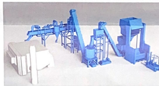
Späneaufbereitungsanlage zum Einschmelzen der Aluminiumspäne
