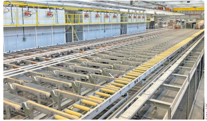
Die neue Reckbank hat eine Reckkraft von bis zu 200 Tonnen
