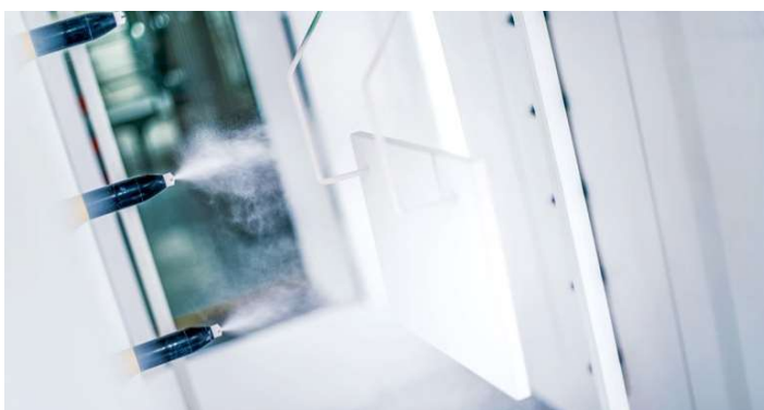
Die Vorteile der Pulverbeschichtung auf Metallen finden seit geraumer Zeit auch auf Substraten wie Holz Anwendung. Foto: IGP
