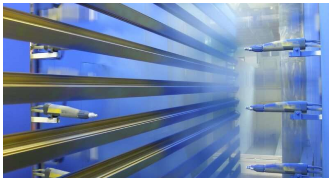
Die Kombination von Voranodisation und Beschichtung sorgt für höchsten Korrosionsschutz der Produkte. Foto: VOA
