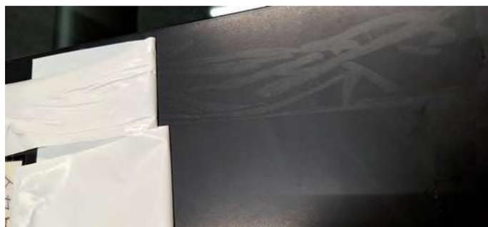
Prüfstücke Kleberückstände nach Klimawechseltest
