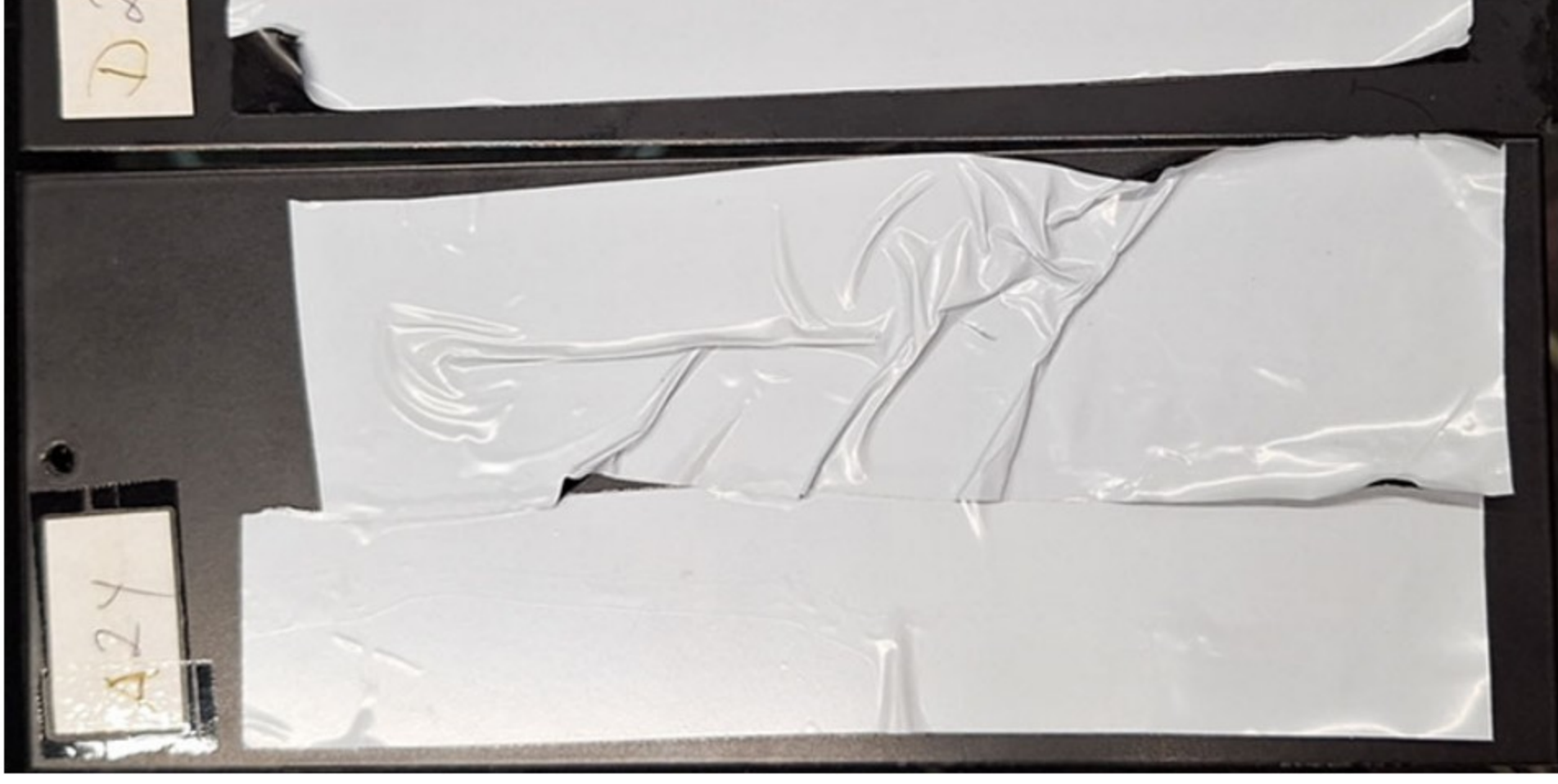
Schutzfolien für Aluminium-Oberflächen im Test: Prüfstücke für den Klimawechseltest (Bild: VOA)
