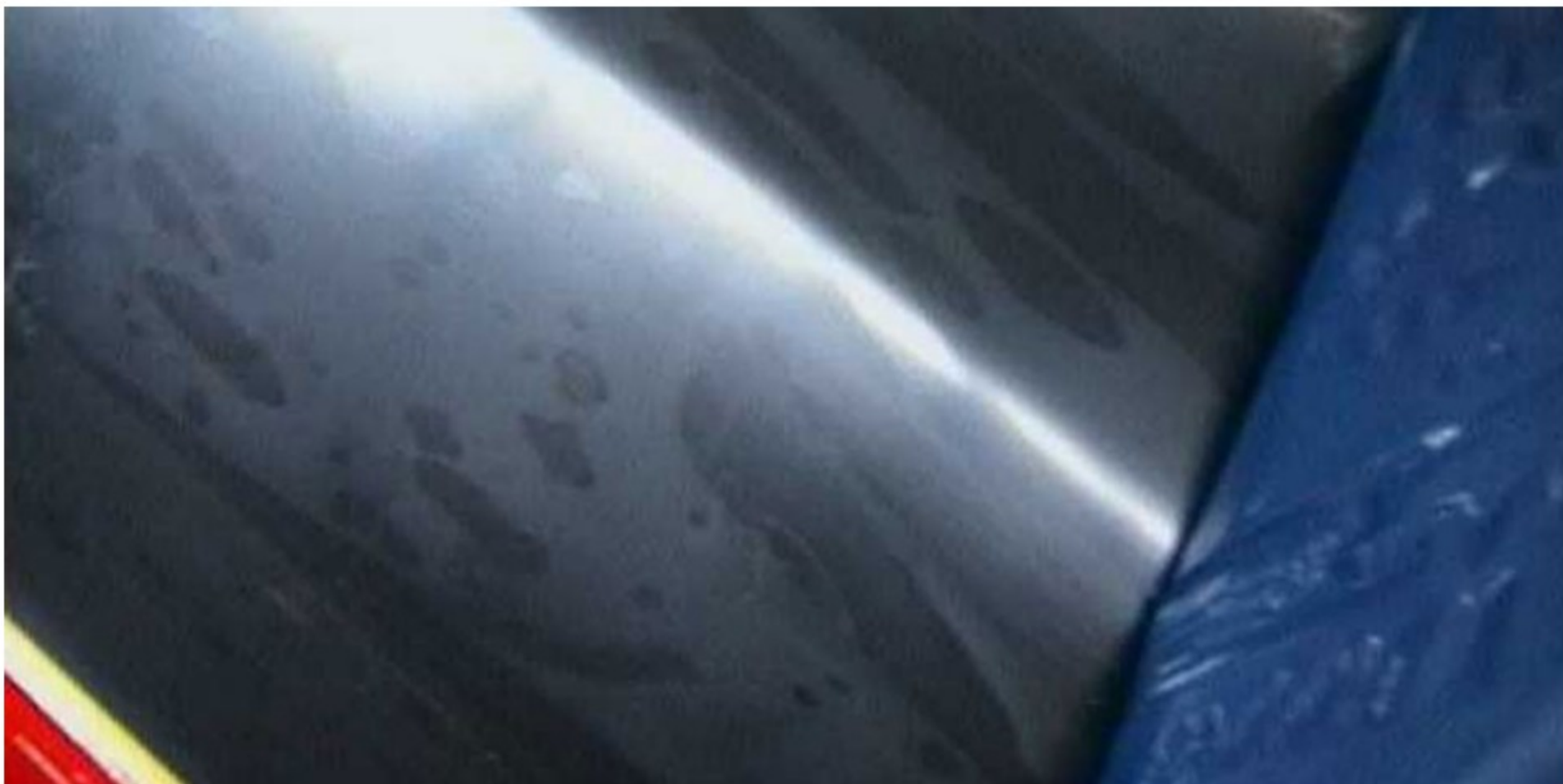
Ghosting – fleckenförmige Bereiche mit leicht höherem Glanzwert auf der beschichteten und mit speziellen Wachsen mattierte Oberfläche (Bild: Tesa SE)
