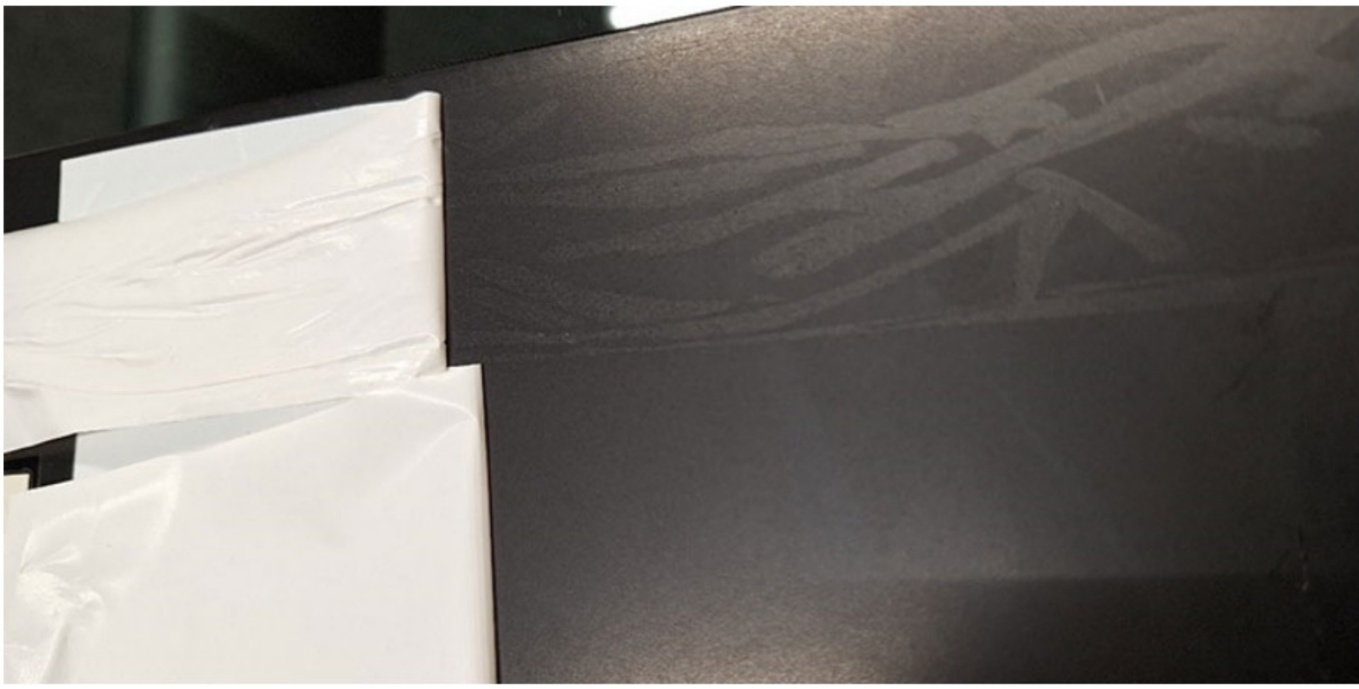
Prüfstücke für Kleberückstände auf Oberflächen nach dem Klimawechseltest (Bild: VOA)
