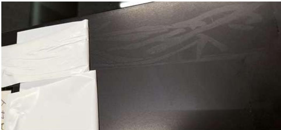
Prüfstücke Kleberückstände nach Klimawechseltest (Bild: VOA)
