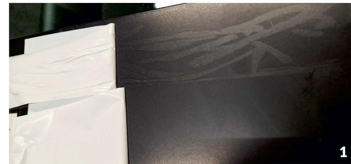
1: Die Prüfstücke weisen Kleberückstände nach dem Klimawechselstest auf. Foto: VOA
